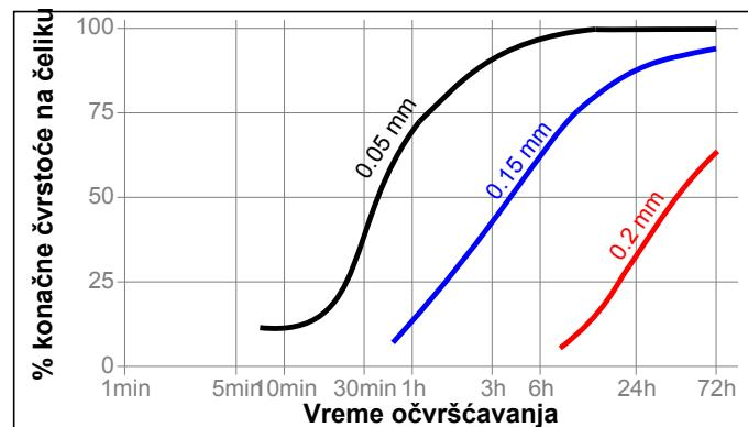
**Brzina očvršćavanja u zavisnosti od aktivatora**
